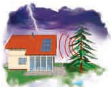
Uderzenia w pobliski obiekt i wyindukowanie przepięcia wewnątrz budynku.
